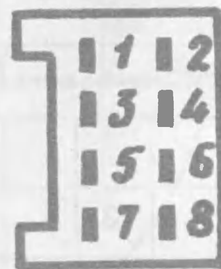
Рис. 2. Вид на разъем со стороны ответной части: 1 — 8 — номера контактов.
